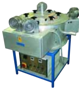
Zweifrequenz-Versuchsanlage mit 4 Magnetrons für F+E Dual frequency test unit with 4 magnetrons for R+D
